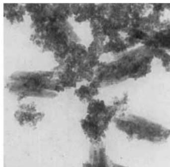
Fig. 4. Gemisch von amorphem Eisenhydroxyd und \alpha - \text{FeOOH} in alkalischem Milieu gealtert (Vergrößerung 40000 \times ).
